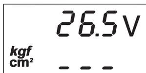
б) при отсутствии датчика «Давление масла»
